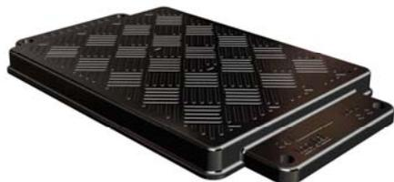
El objetivo principal de la Baliza CB\_ASFAD\_U\_3C es la de transmitir al tren la información de los aspectos puntuales según las condiciones de vía en vías de doble ancho. La Baliza transmite esta información cuando el captador del tren pasa sobre la baliza y sintoniza con esta mediante acoplamiento inductivo. (Subsistema de Captación instalado en el tren).
